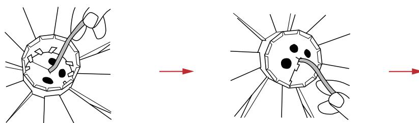
Birne und Fassung in den Sockel hinabsenken und das erste Aufhängungselement an den "Lappen" vorbei hinunterdrücken. Das zweite Aufhängungselement mit der Spitze nach unten am Kabel montieren und es als Führung in den Sockel absenken.
