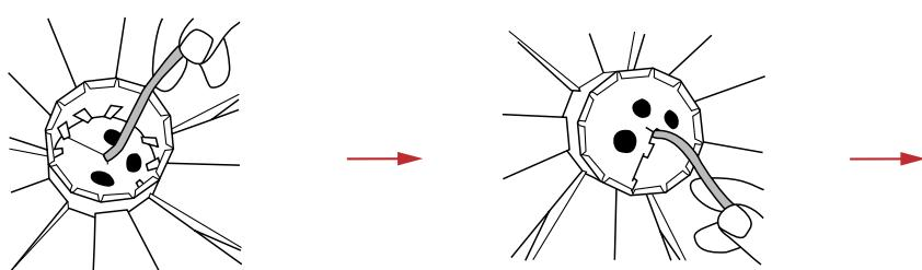
将灯泡和灯泡插口放入柱体，然后按下第一个悬挂元件直至越过“舌片”。将第二个悬挂元件安装到电缆上，顶端冲下，然后将其放入柱体中，以确保灯具可垂直悬挂。
