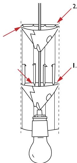
Introducir la bombilla y el portalámparas en el soporte, y presionar la primera pieza suspensora pasando por las pestañas. Ensamblar la segunda pieza suspensora en el cable con el pico hacia abajo e introducirla dentro del soporte como guía.
