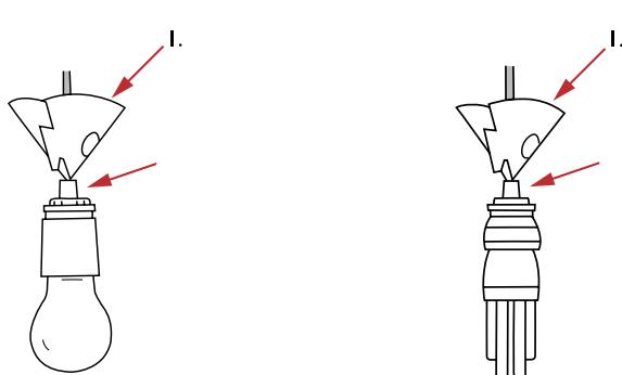
Ripiegare su se stesso il primo elemento di sospensione attorno al cavo di alimentazione, con il vertice rivolto verso il basso. **IMPORTANTE!** Il portalam-pada e l'elemento di sospensione devono essere distanziati. È pertanto **NECESSARIO** montare sul cavo il distanziale in dotazione come illustrato nella figura.
