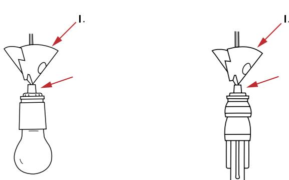
« Enrouler » le premier élément de suspension autour du câble, en orientant la pointe vers le bas. **ATTENTION!** Il est impératif de conserver un certain écart entre la douille et l'élément de suspension. Le raccord livré **DOIT** donc être monté sur le câble, comme indiqué sur le croquis.
