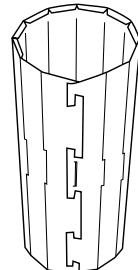
将中心元件卡在一起，形成一个12面的柱体。
