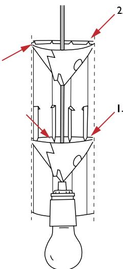
電球とねじ込み口を土台の中に下ろし、最初の吊り下げエレメントを“翼部”をバイパスして押し込んでください。
