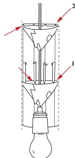
De lamp en de fitting in de sokkel laten zakken en het eerste ophangelement naar beneden, langs de 'vaandels' duwen. Het tweede ophangelement op het snoer monteren met de punt naar beneden. In de sokkel laten zakken als stuur.
