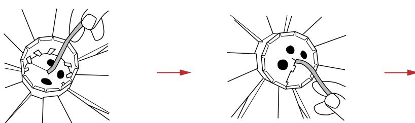
Pære og fatning sænkes ned i sokkel, og første ophængningselement presses ned forbi "fanerne". Det andet ophængningselement samles på ledningen med spidsen nedad. Sænkes ned i soklen som styr.
