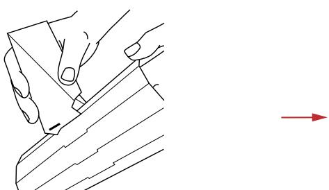
Die Lappen der Bauteile in die Sockelschlitz stecken
