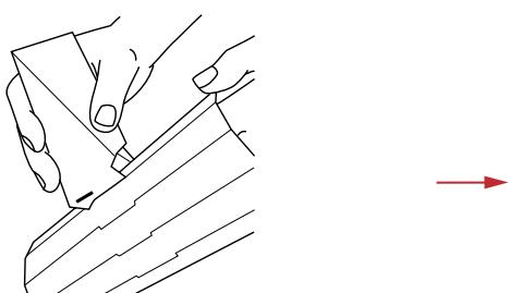
Insérer l'onglet des éléments dans les rainures du socle et rabattre les bouts à l'intérieur du socle.
