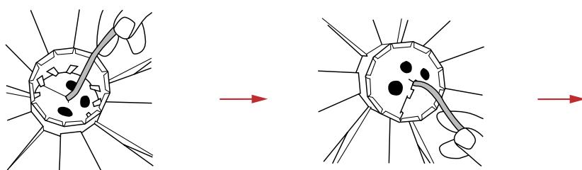
Introdurre la lampadina e il portalampada nell'elemento base, e premere il primo elemento di sospensione verso il basso davanti alle linguette. Montare quindi il secondo elemento di sospensione attorno al cavo di alimentazione, con il vertice rivolto verso il basso. Introdurre nell'elemento base.
