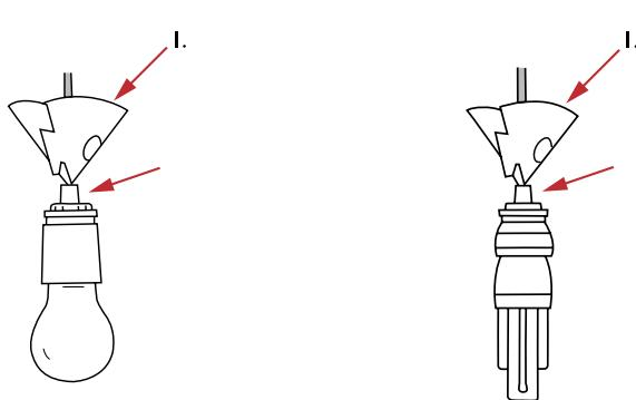
Det første ophængselement "knipes" sammen om ledningen – med spidsen nedad. **VIGTIGT!** Der skal være afstand mellem fatning og ophængselement. Derfor **SKAL** vedlagte nippel monteres på ledningen, som vist på tegningen.
