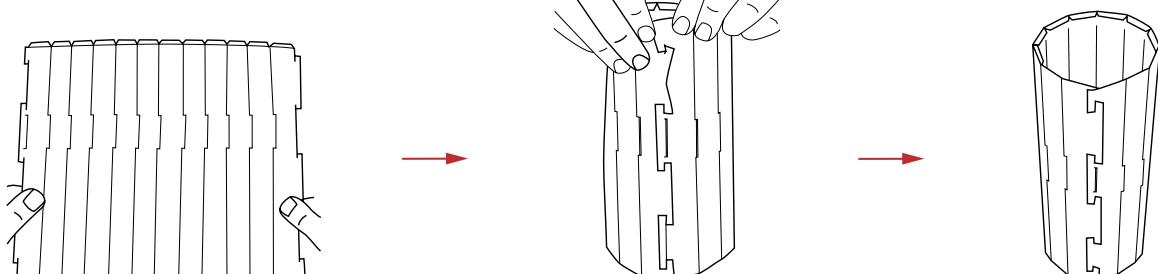
« Enrouler » le socle de façon à former un cylindre dodécagonal. Orienter le bord replié vers le haut.
