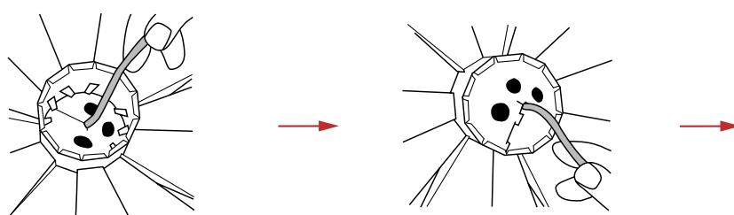
Descendre l'ampoule et la douille dans le socle et faire passer le première élément de suspension au-delà des « onglets ». Monter le second élément de suspension sur le câble en orientant la pointe vers le bas. Descendre l'élément dans le socle où il servira de pièce de guidage.
