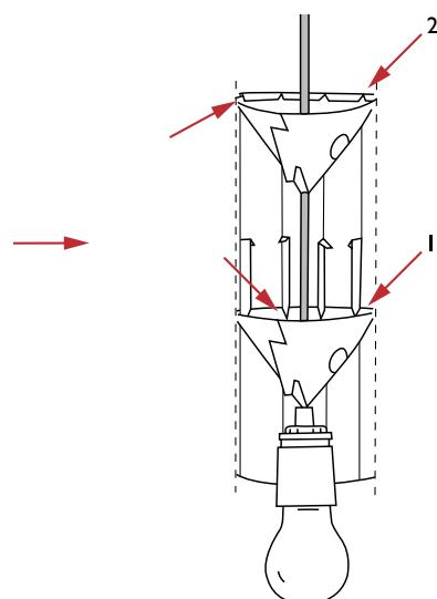
Pæren og lampedelen senkes ned i sokkelen, og første opphengsdel presses ned forbi "fanene". Den andre opphengsdelen settes sammen over ledningen med spissen vendt nedover. Senkes ned i sokkelen som styrestang.
