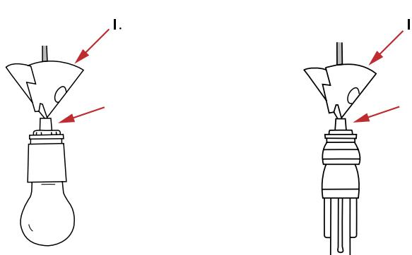
将第一个悬挂元件卡在相应的电缆上，悬挂元件顶端冲下。
