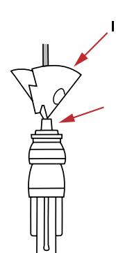
Den første opphengsdelen settes sammen rundt ledningen med spissen vendt nedover. **VIKTIG!** Det må være avstand mellom lampedelen og opphengsdelen. Derfor **MÅ** vedlagte kilehake monteres på ledningen som vist på tegningen.
