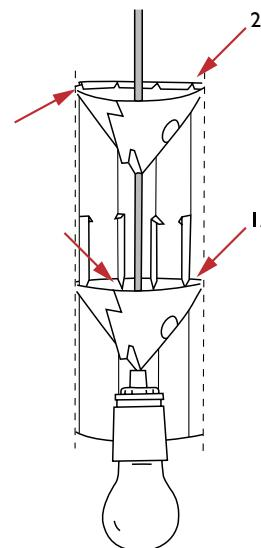
Sänk ner glödlampan och fattningen i sockeln och pressa ner den första upphängningsdelen förbi "flikarna". Sätt fast den andra upphängningsdelen på sladden med spetsen neråt. Sänk ner den i sockeln som styrdel.
