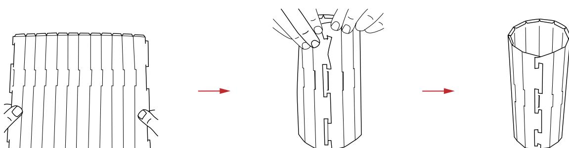
Enrollar y enganchar el soporte formando un cilindro de 12 lados con la parte de las pestañas hacia arriba.
