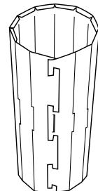
Den Sockel zu einem 12-eckigen Zylinder "zusammenknipsen".
