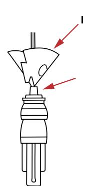
"Knip" fast den första upphängningsdelen runt sladden – med spetsen neråt. **VIKTIGT!** Det måste vara ett mellanrum mellan fattningen och upphängningsdelen. Därför **MÅSTE** den bifogade nippeln monteras på sladden enligt ritningen.
