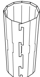
Ripiegare su se stesso l'elemento di base formando un cilindro a dodici lati. L'estremità con il bordo ripiegato all'interno deve essere rivolta verso l'alto.
